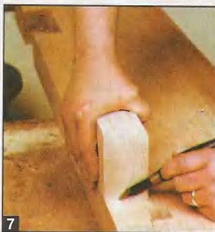
7 После подрезки боковых сторон резбовых блоков под углом размечают пазы для них. Трапециевидная форма плюс клей повышают механическую прочность крепления.
