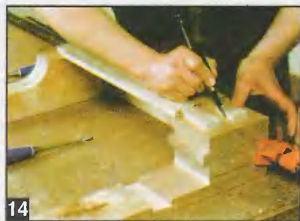
Копрус тисков имеет коробчатую конструкцию: боковина, нижняя и верхняя доски и щеки соединены на клею «ласточкиным хвостом». Для точности соединений разметку ведут по месту.
