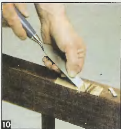
10 Древесину выбирают стамеской на глубину, равную толщине карты петли.
