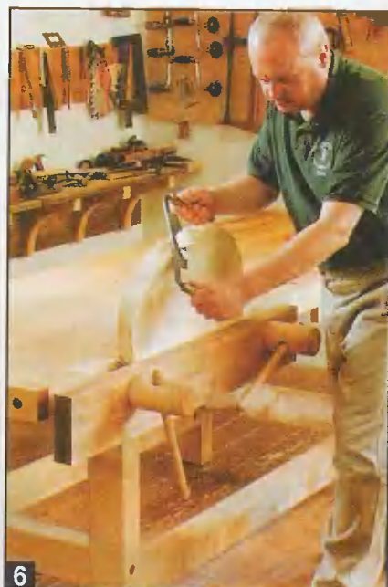
6 Размеры и прочность. Мощные деревянные винты, расположенные на значительном расстоянии друг от друга, позволяют закрепить широкие детали, а тиски достаточно длинные, чтобы поддержать широкую доску при обработке ребер.
