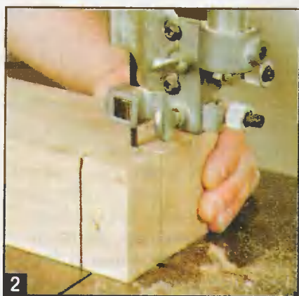
2 Щеки запиливают ленточной пилой. При выборке гнезд в ножках сверлят отверстия.
