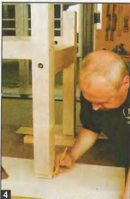
4 Определение положения гнезд для стоек на брусе из клена. Прежде асего, кладут брус лицевой стороной вниз и выравнивают задние стойки.
