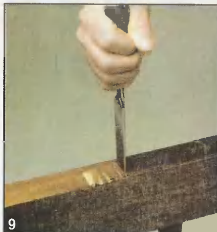
9 Легкими ударами руки или киянки по стамеске делают насечки на глубину около 2 мм и удаляют верхний слой древесины.
