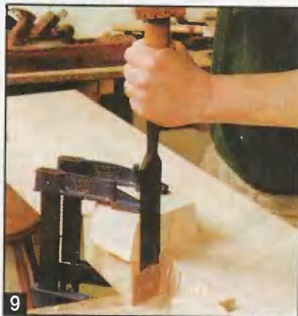
9 После удаления лишнего материала подрезают боковые стороны. В качестве направляющей для стамески используют один из резьбовых блоков.
